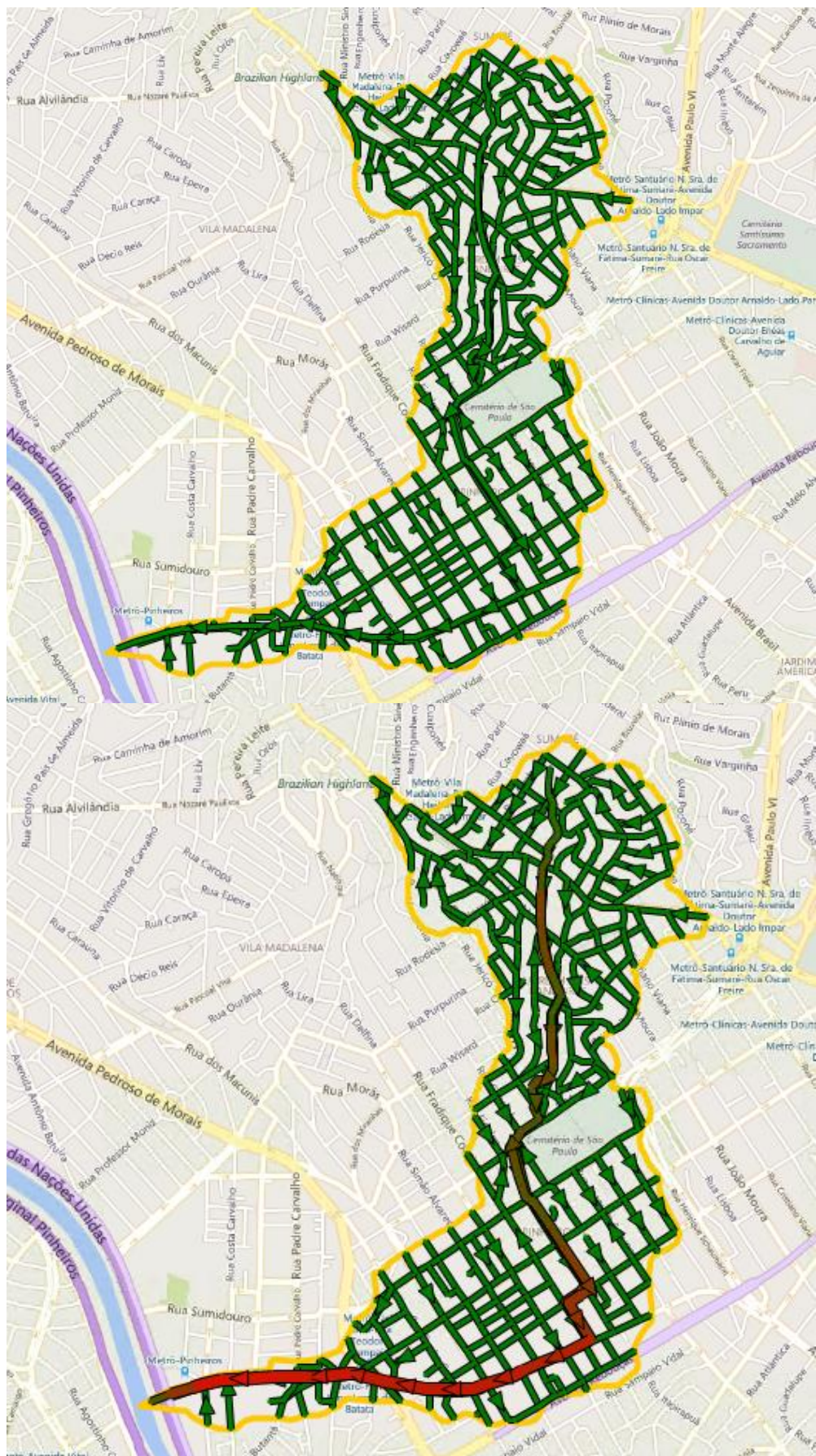
Figura 4-30: Comparação dos níveis d'água dos condutos antes e no momento mais crítico da chuva de projeto, evidenciando a saturação da galeria.
