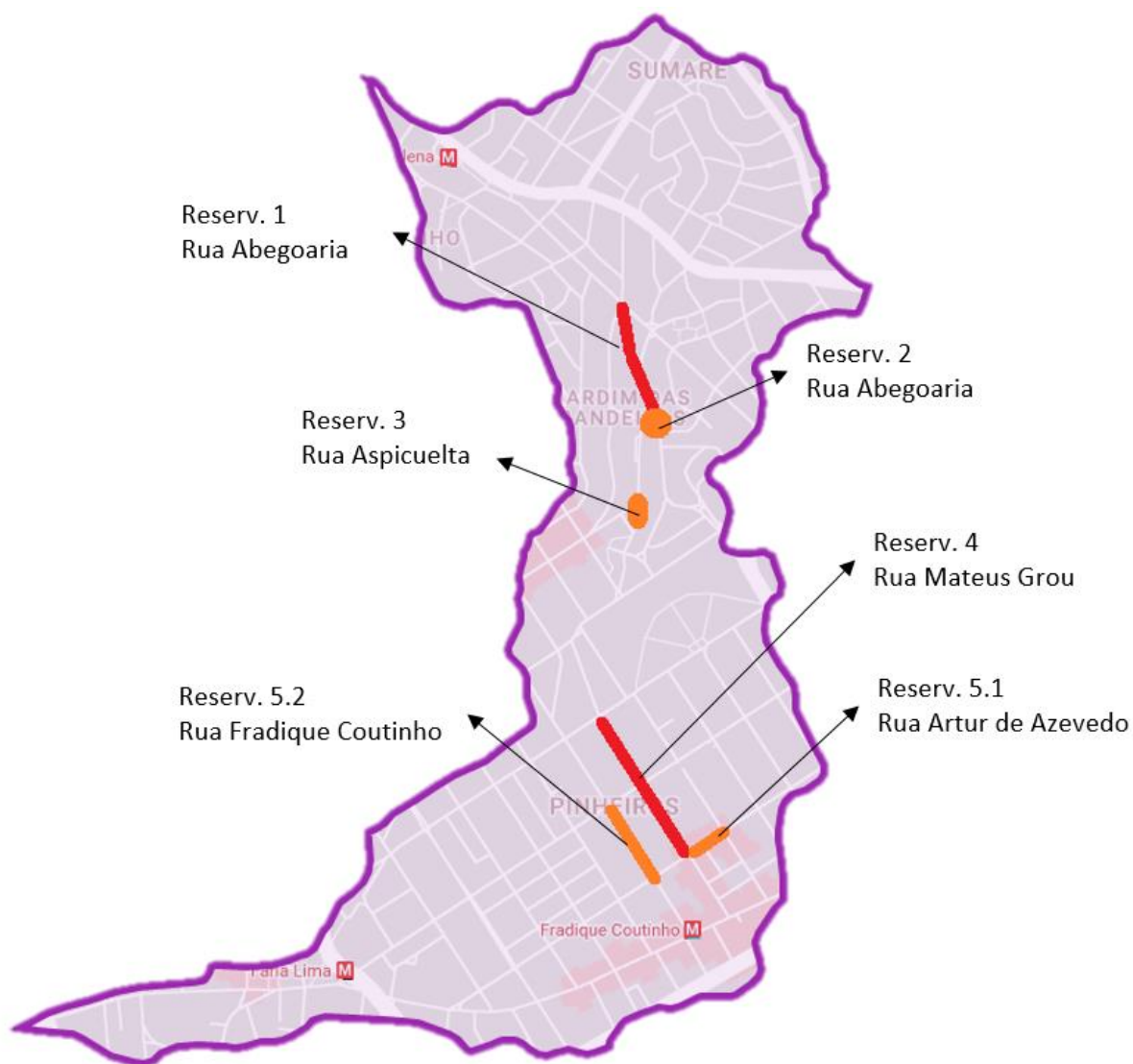
Figura 4-43: Modelo da bacia (ruas, galeria e reservatórios) pós intervenções.
